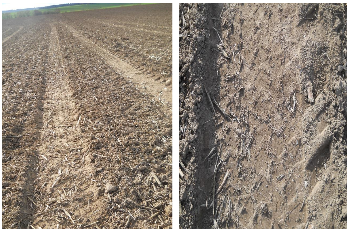
Příloha 6: Var. 6 - naložená souprava traktoru s návěsem s podhuštěnými pneumatikami (profil koleje)
