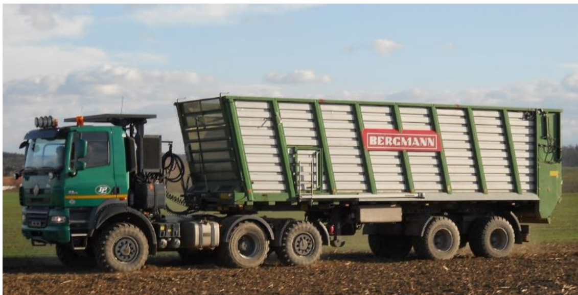
Obrázek 4 Souprava TATRA Phoenix agrotahač 6x6 s návěsem BERGMANN HW-11 (foto: Jan Novák)
