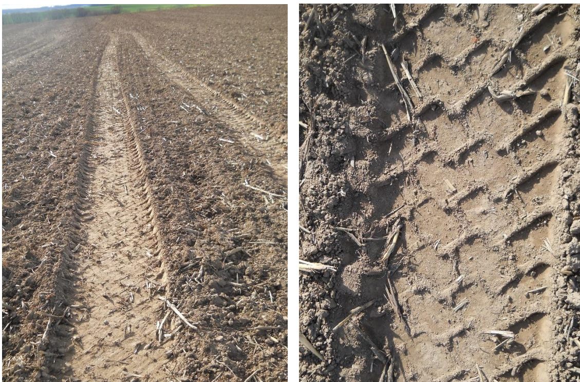
Příloha 8: Var. 8 - naložená souprava agrotahače s návěsem s podhuštěnými pneumatikami (profil koleje)
