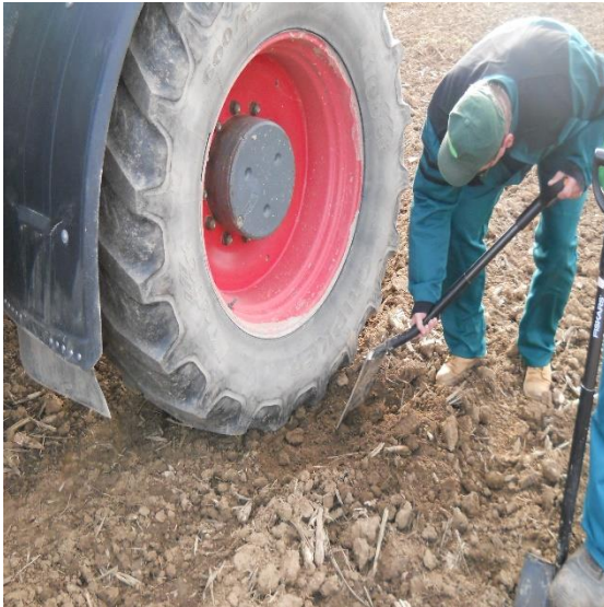
Obrázek 11 (vlevo) Obnažování boku pneumatiky pro následné měření (foto: Jan Novák) Obrázek 12 (vpravo) Měření šířky otisku pneumatiky ve vyjeté stopě (foto: Jan Novák)
