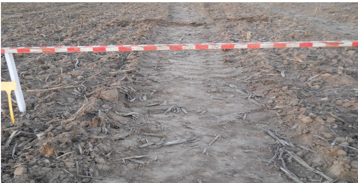
Obrázek 14 Měření profilu vyjeté koleje pomocí šrafované latě (foto: Jan Novák)
