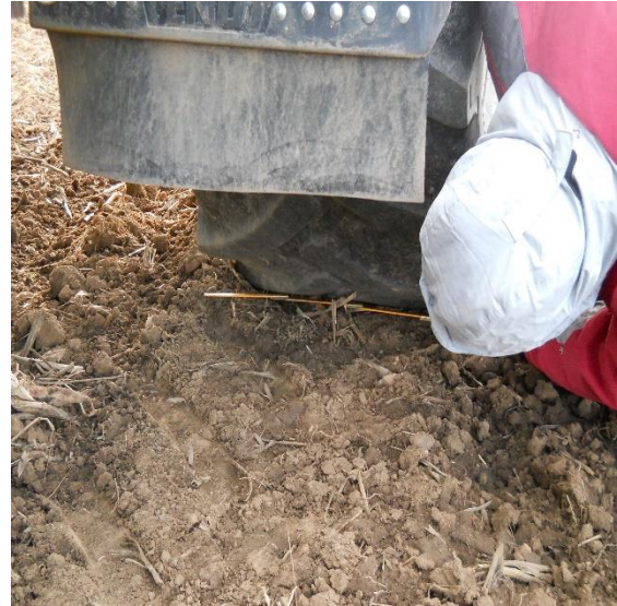
Obrázek 11 (vlevo) Obnažování boku pneumatiky pro následné měření (foto: Jan Novák) Obrázek 12 (vpravo) Měření šířky otisku pneumatiky ve vyjeté stopě (foto: Jan Novák)
