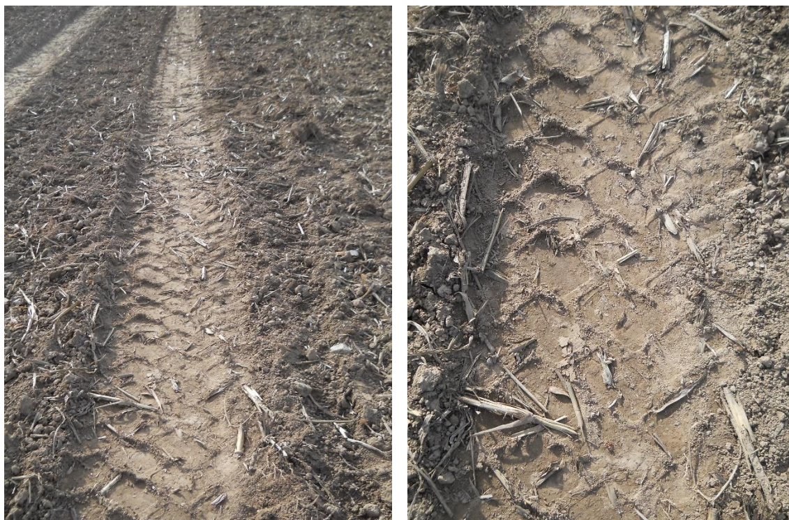
Príloha 4: Var. 4 - prázdna souprava agrotahače s návěsem s podhuštěnými pneumatikami (profil koleje)
