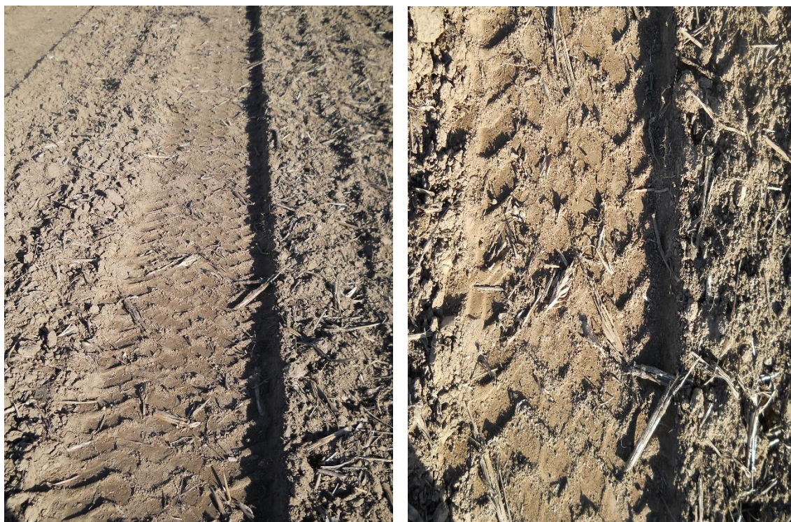
Príloha 5: Var. 5 - naložená souprava traktoru s návěsem s nahuštěnými pneumatikami (profil koleje)
