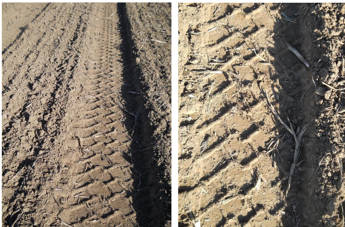
Příloha 7: Var. 7 - naložená souprava agrotahače s návěsem s nahuštěnými pneumatikami (profil koleje)
