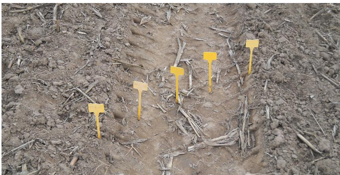
Obrázek 10 Označení vpichů penetrometrického měření (foto: Lubomír Neudert)
