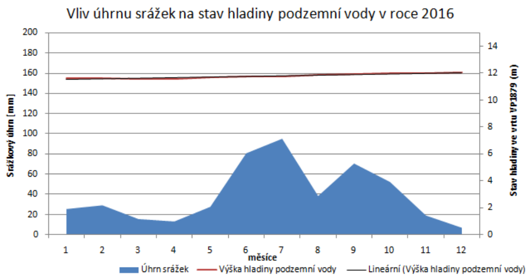
Příloha 16: Graf vlivu úhrnu srážek na hladinu podzemní vody ve vrtu VP1879 v roce 2016 (zdroj: autorka)
