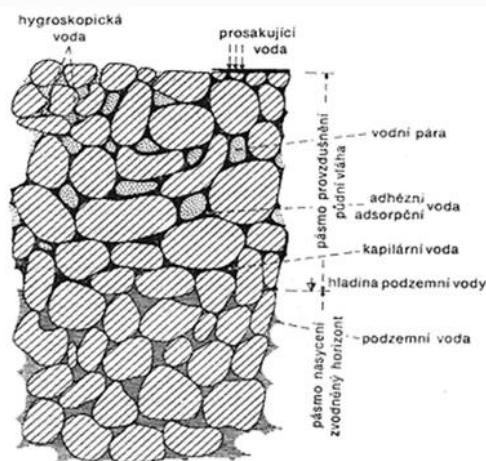
Obr. 1: Rozložení druhů podpovrchové vody v horninách (Netopil, 1972)
