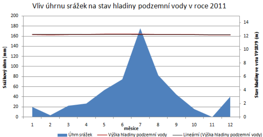
Příloha 11: Graf vlivu úhrnu srážek na hladinu podzemní vody ve vrtu VP1879 v roce 2011 (zdroj: autorka)
