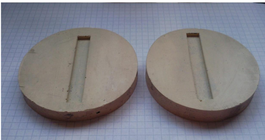
Obr. 21: Formičky z LUKOPRENU pro odlévání creepových vzorků
