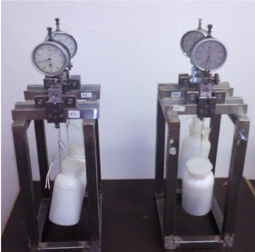
Obr. 23: Zkušební stojany pro měření creepu akrylátových lepidel
