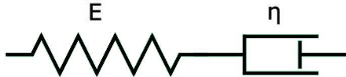
Obr. 16: Schéma Maxwellova modelu.
