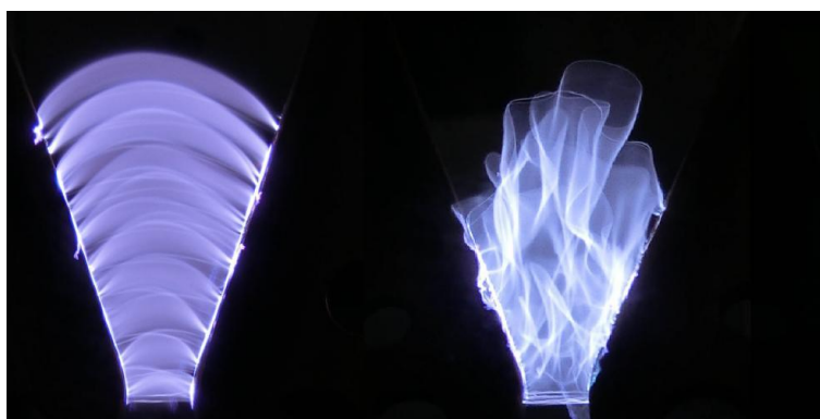
Obrázek 4 Fotografie klouzavého obloukového výboje při dvou různých průtocích argonu [9]
