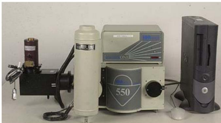
Obrázek 13 Skutečný pohled na optický emisní spektrometr TRIAX 550 [30]
