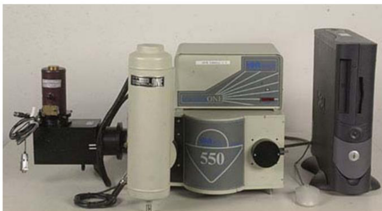
Obrázek 13 Skutečný pohled na optický emisní spektrometr TRIAX 550 [30]
