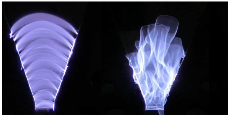
Obrázek 4 Fotografie klouzavého obloukového výboje při dvou různých průtocích argonu [9]
