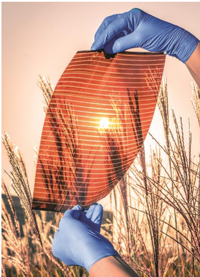
Obr. č. 10 – Flexibilní perovskitový solární článek [23]
