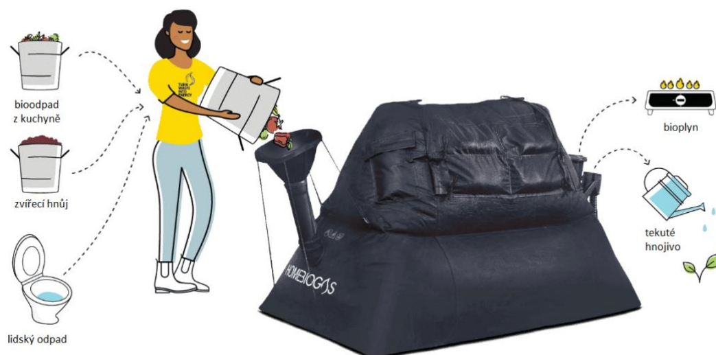
Obr. č. 11 – Princip domácí bioplynové stanice [24]
