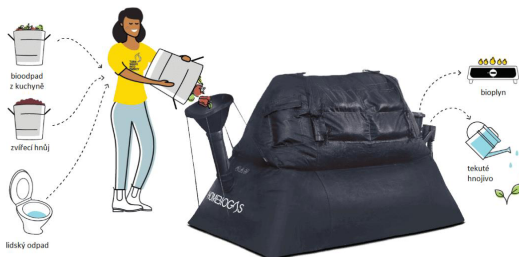
Obr. č. 11 – Princip domácí bioplynové stanice [24]
