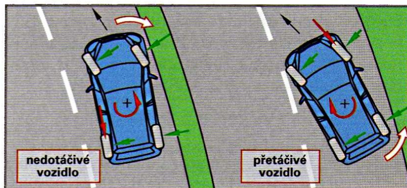
Obr. 11: Nedotáčivost a přetáčivost vozidla [3]
