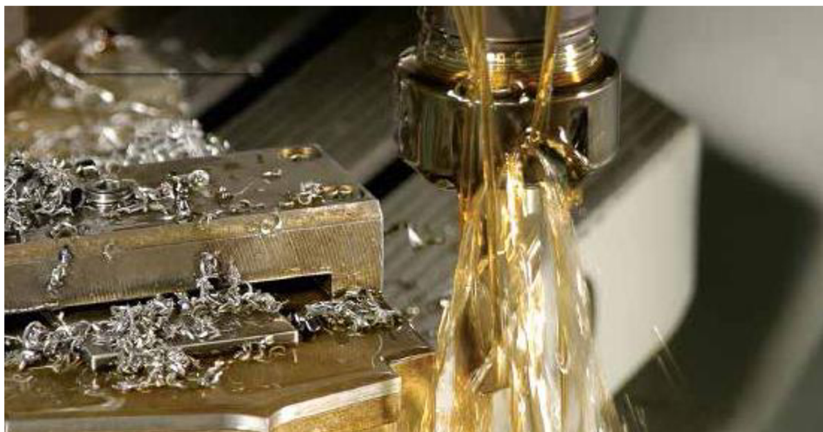
Obr. 1.4 Obrábění s řezným olejem [47].
