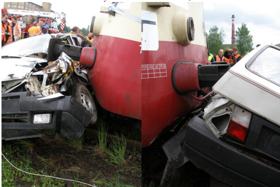
Obr. P3.19: Výsledek druhého nárazového testu
