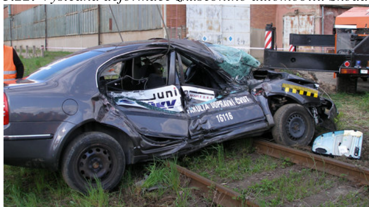
Obr. P3.22: Výsledná deformace zkušebního automobilu Škoda Superb
