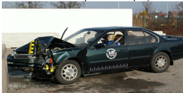
Obr. P3.10: Nissan Maxima po střetu s nepohyblivou bariérou
