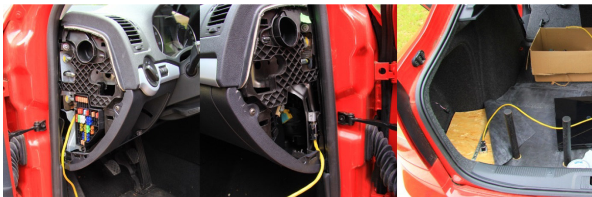
Obr. 6.9: Umístění akcelermetrů ve zkušebním vozidle: vlevo akcelermetr 1, uprostřed akcelermetr 2, vpravo akcelermetr 3
