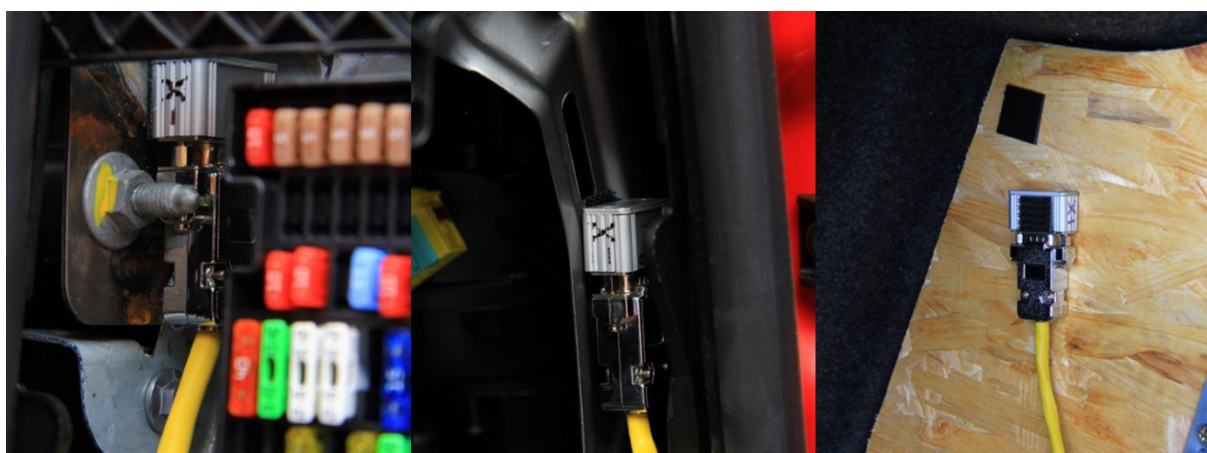
Obr. 6.10: Detail umístění akcelermetrů: vlevo akcelermetr 1, uprostřed akcelermetr 2, vpravo akcelermetr 3
