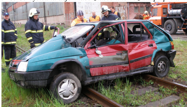
Obr. P3.15: Výsledná deformace zkušebního vozidla po prvním testu
