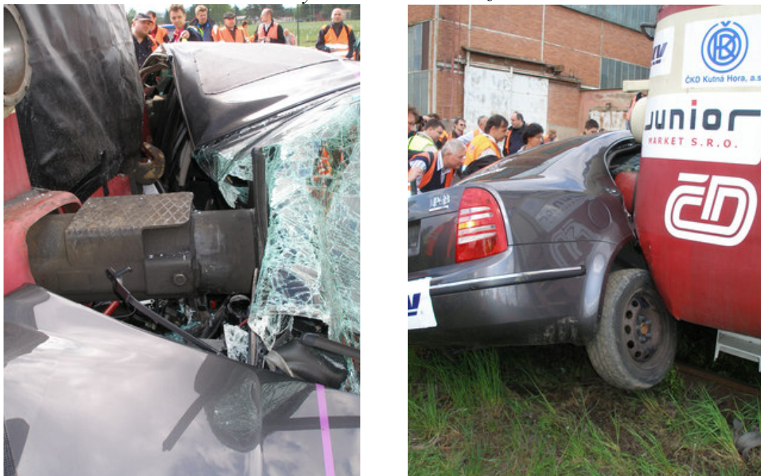
Obr. P3.21: Výsledek třetího nárazového testu
