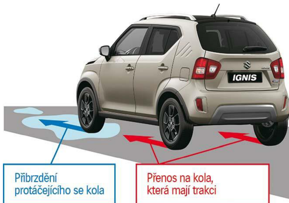
Obr. 19 – Znárodnění funkce Grip Control na vozidle Suzuki Ignis [4]
