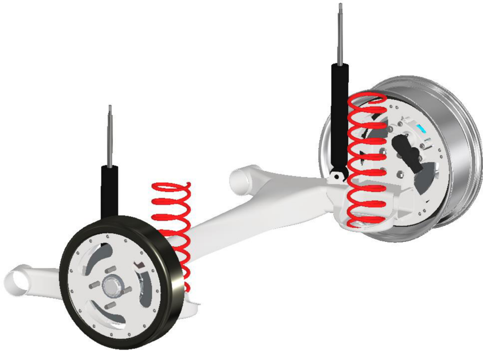
Obr. 43 – Model nové zadní nápravy – zadní pohled
