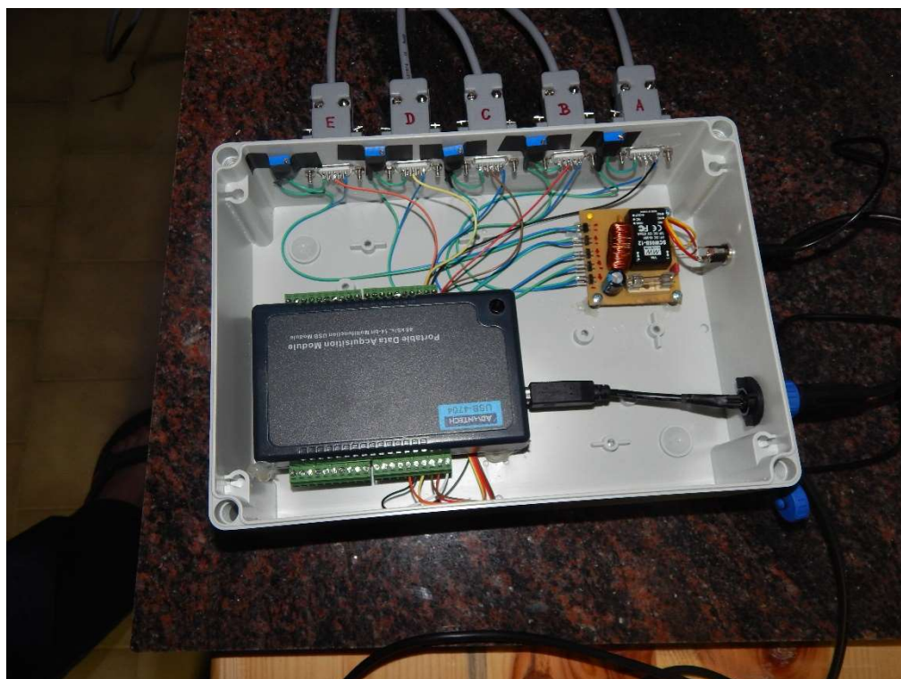
Příloha 10-9 Sběrná karta převádí signál z potenciometru do PC
