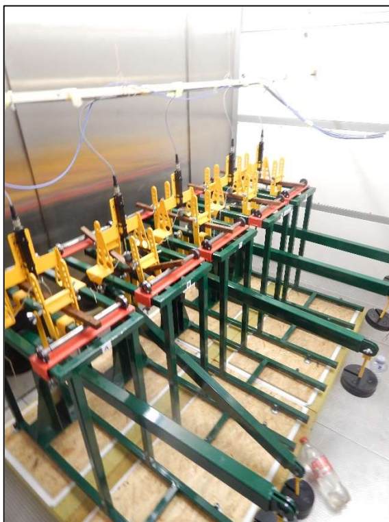
Příloha 10-6 Detail zatěžovací hlavy, podpěr a držáku potenciometru
