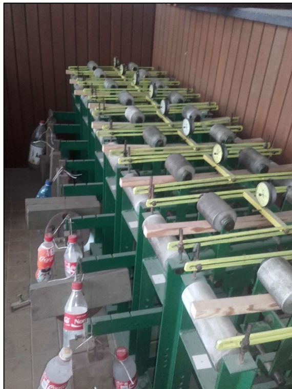
Příloha 10-4 Creepové jednotky ve vnější kryté expozici
