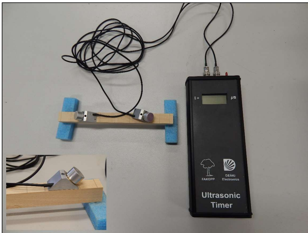
Příloha 10-11 FAKOPP přístroj na měření dynamického modulu.
