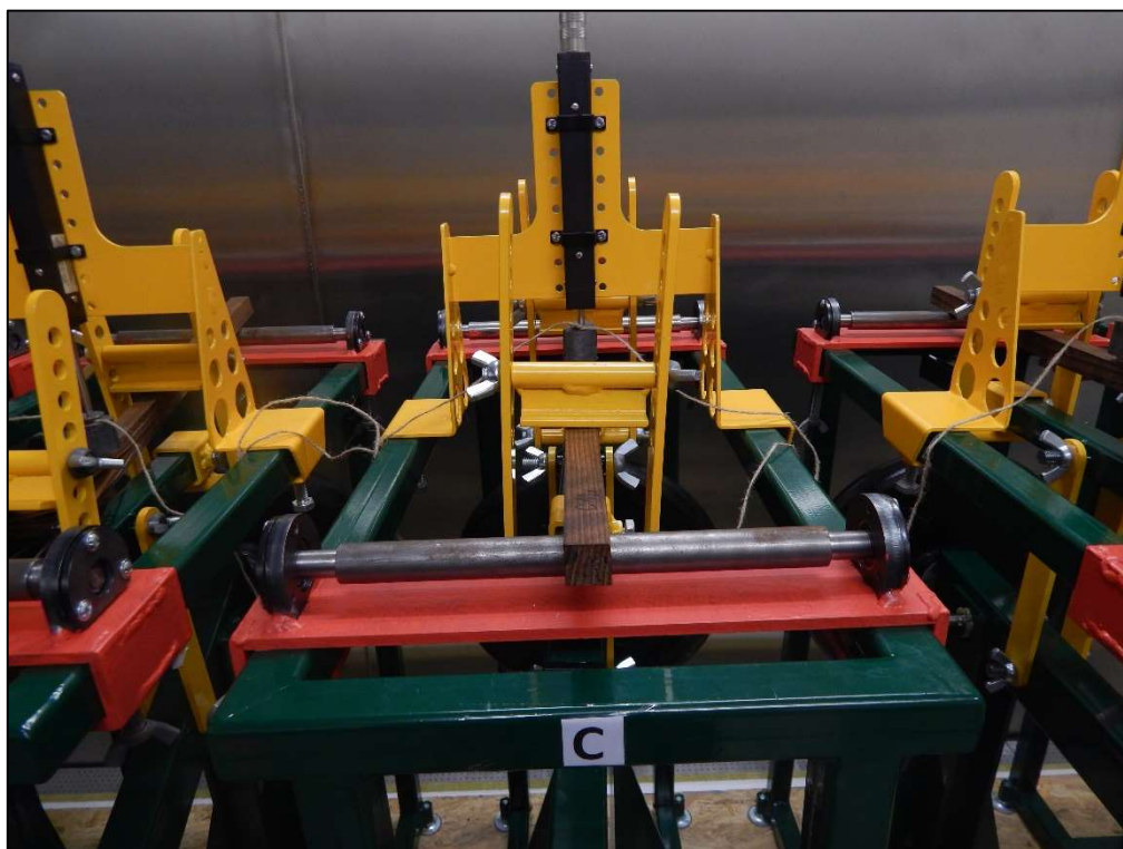
Příloha 10-6 Detail zatěžovací hlavy, podpěr a držáku potenciometru
