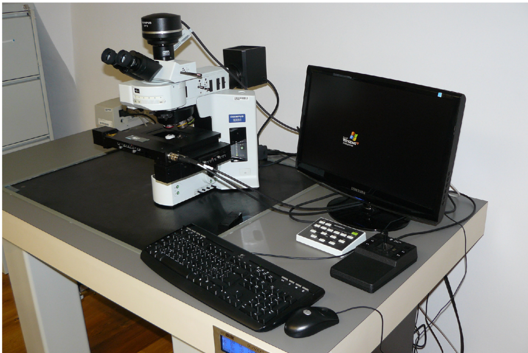
Obr. 3.1: Fotka zachytáva vybavenie laboratória. Okrem mikroskopu Olympus BX61 a radiaceho počítača, môžeme vidieť aj ovládacie jednotky (U-HSTR2 s bielymi tlačidlami a čiernu s joystickom) a samotný stabilizačný stôl, ktorého čierna vyznačená plocha tlmí aj najmenešie vibrácie.
