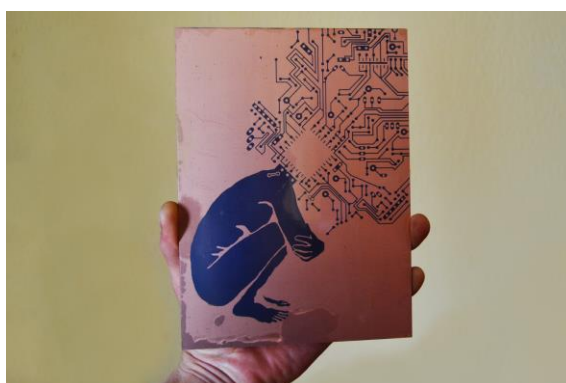
Obrázek 20: vyvolaná předloha připravená k leptání
