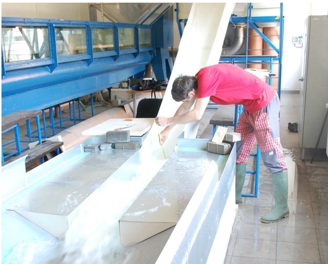
Obr. 37 Měření hloubky h_1 ocelovou měrkou
