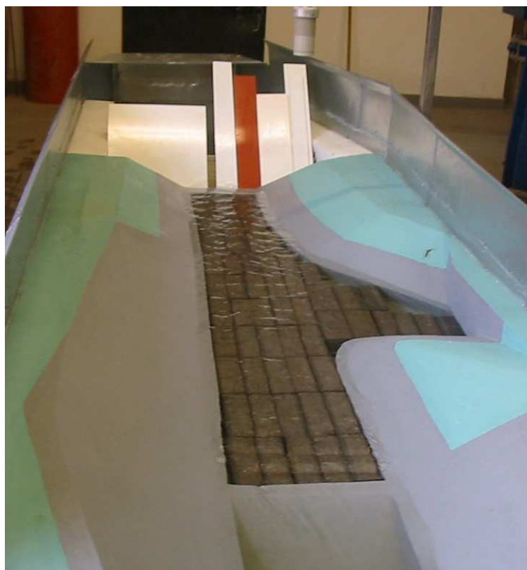
Obr. 17 Detail odpadního koryta vyskládaného dlažebními kostkami
