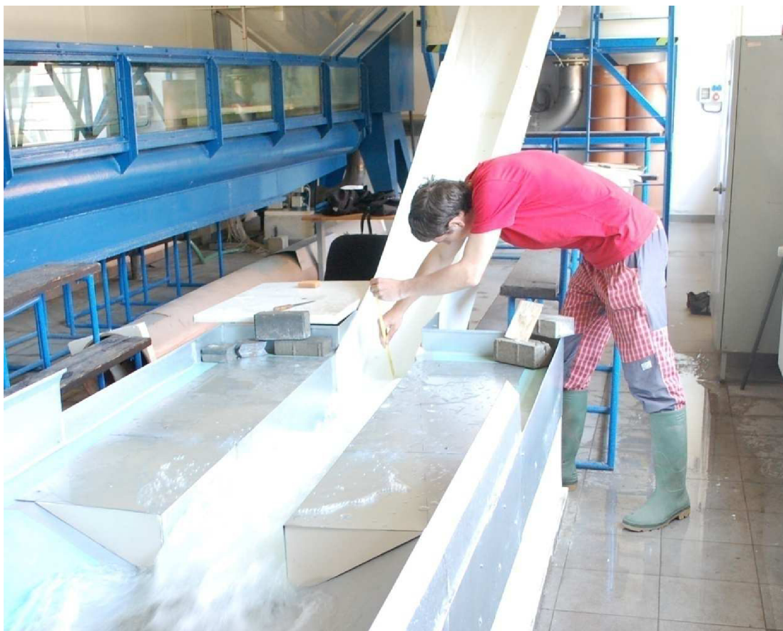
Obr. 37 Měření hloubky h_1 ocelovou měrkou
