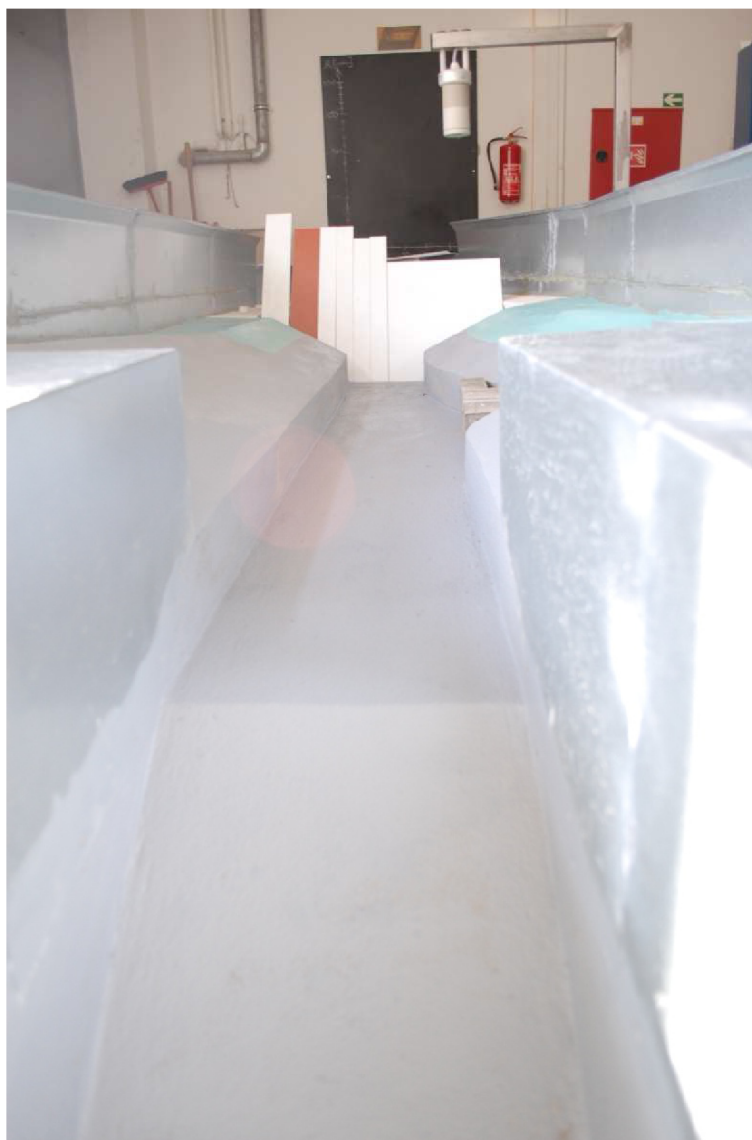
Obr. 38 Detail „odseknuté“ horní části prahu vývaru (M-9 až M-14)
