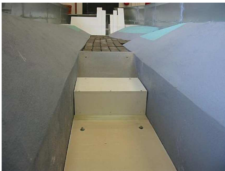
Obr. 13 Detailní pohled na model se zvýšeným dnem a jedním příčným prahem
