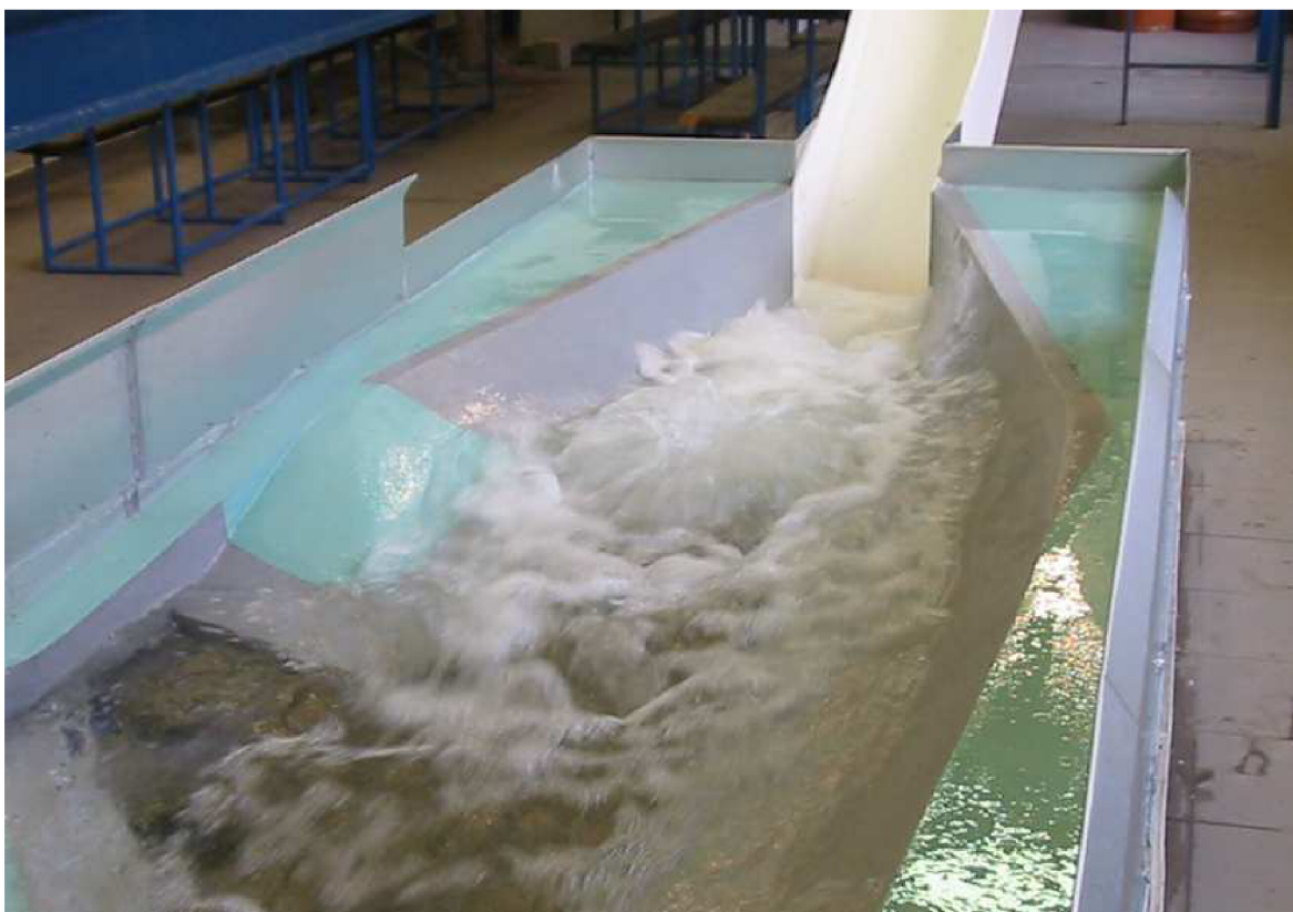
Obr. 8 VS v konoidálním vývaru
