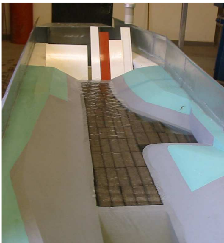
Obr. 17 Detail odpadního koryta vyskládaného dlažebními kostkami
