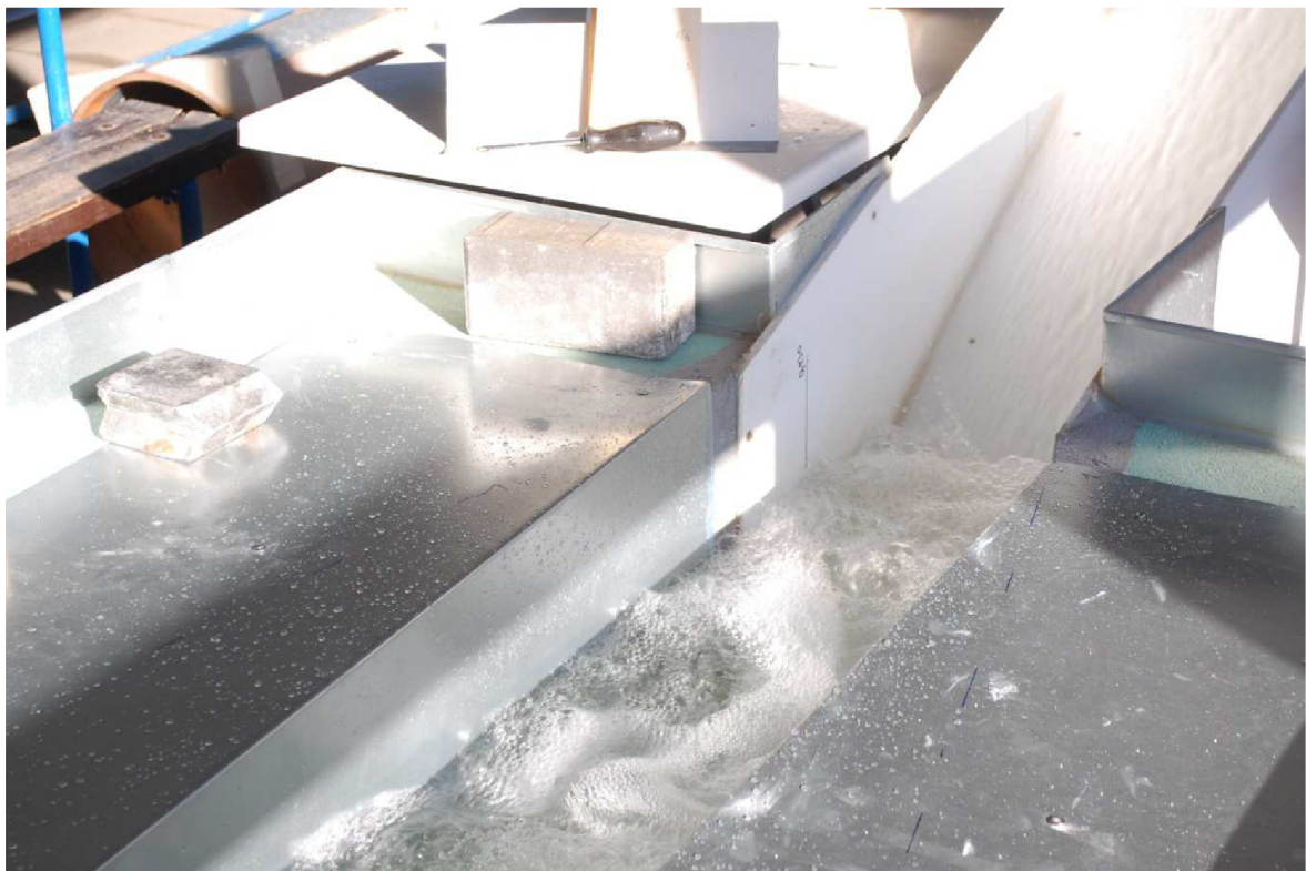
Obr. 5 Vzdutý VS v prizmatickém korytě
