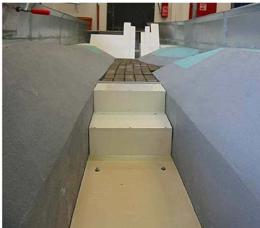
Obr. 16 Detailní pohled na model se zvýšeným dnem a dvěma příčnými prahy
