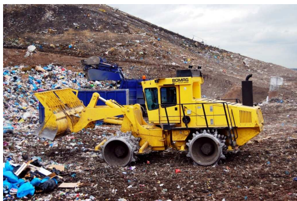
Foto 4.1 Ukládání odpadu na skládku. Ke zhuňování se využívá kompaktor značky Bomag. (Zdroj: Autor)
