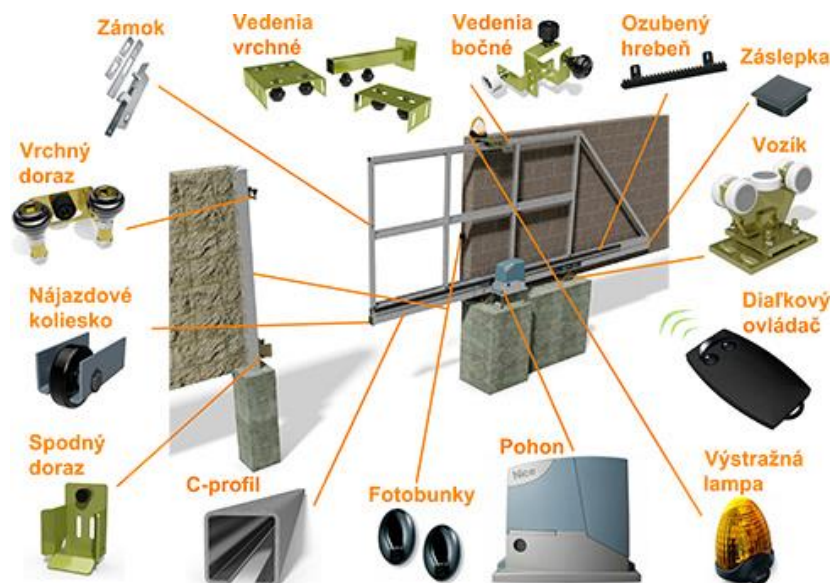
Obr. 1 Jednotlivé komponenty samonosnej posuvnej brány [1]
