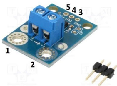
Obr. 33 Popis vstupov a výstupov snímaču prúdu MICROBOT MR003-006.1 [38]
