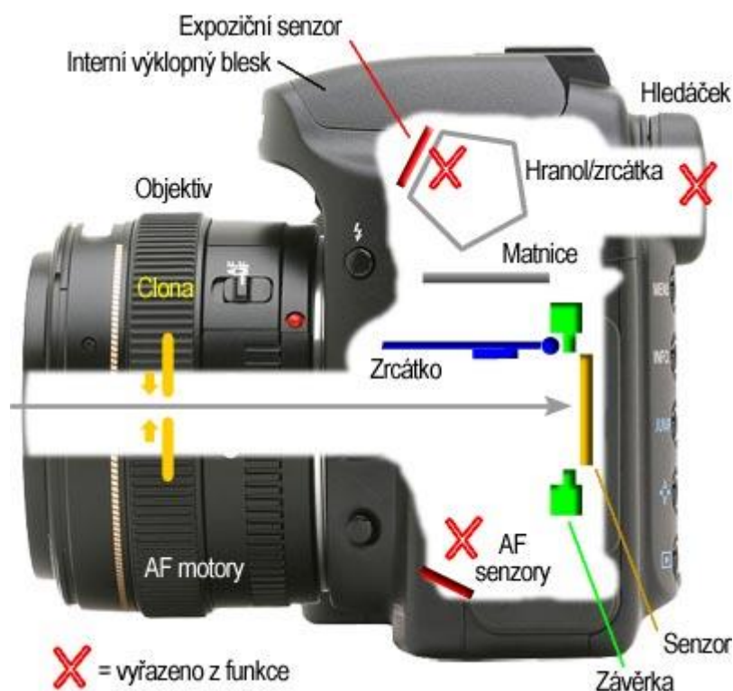
Obrázek 2 - Princip snímání pomocí DSLR
