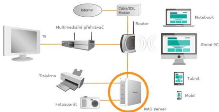
Obrázek 8 - Schéma principu NAS serveru
