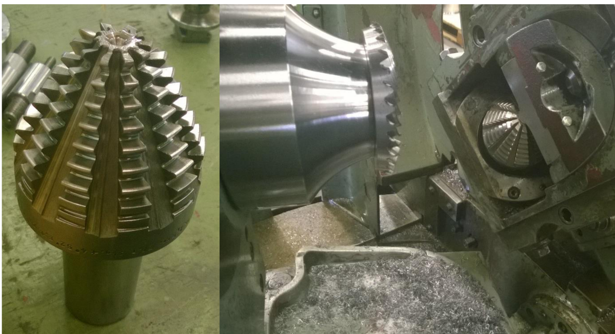
Obr. 2.16 Kuželová odvalovací fréza samostatně (vlevo) a upevněná ve stroji (vpravo).
