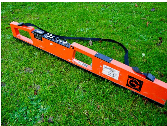
Obr.9 Přístroj na měření elektromagnetické vodivosti, Geonics EM38 Mk2 (Gostomski, 2017)
