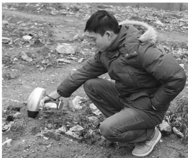
obr. 11 (vlevo) Postup při vytváření spektrálních databází pro spektroskopické měření. (Nocita et al., 2014), obr. 12 (vpravo) Rentgenový spektrometr Lanscientific X3G 700K (Lanscientific, 2017)
