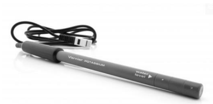
obr.14 Iontově selektivní elektroda k měření koncentrace draslíku, K-BTA (Vernier.com, 2017)
