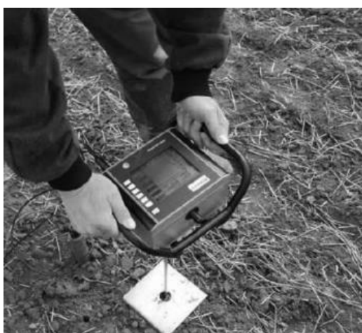
obr.13 Ruční penetrometr (Lukas, Neudert and Křen, 2011)
