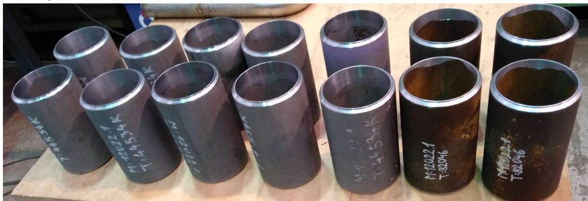
Obr. 29: Připravené vzorky s obrobenými úkosy
