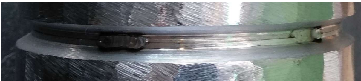
Obr. 32: Sestavený vzorek s mechanicky obroběnými svarovými plochami
