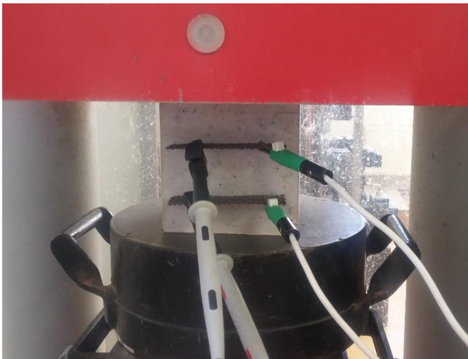
Obr. 3-2 Měření elektrického odporu při cyklickém zatěžování
