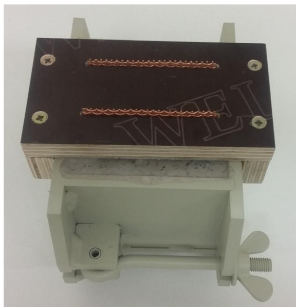
Obr. 3-1 Výroba zkušebních těles s elektrodami
