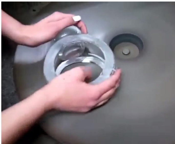
Obrázek 20 Ilustrativní ukázka broušení skleněného prstence na hladině
