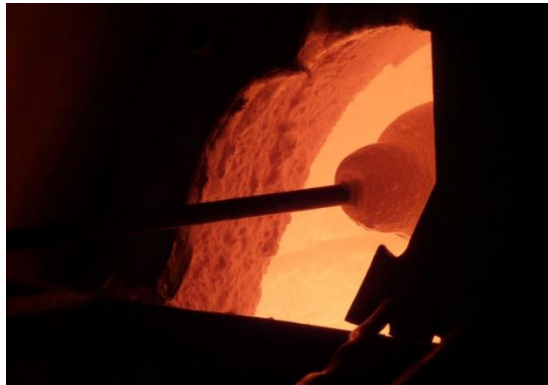
Obrázek 5 Formování roztavené skloviny před vložením do formy
