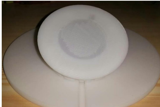
Obrázek 35 Plastové osazení vyrobené pomocí 3D tisku
