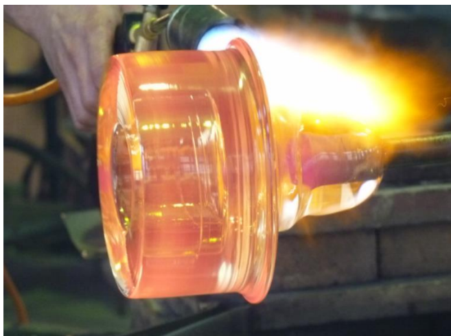
Obrázek 31 Ruční úprava polotovaru z formy
