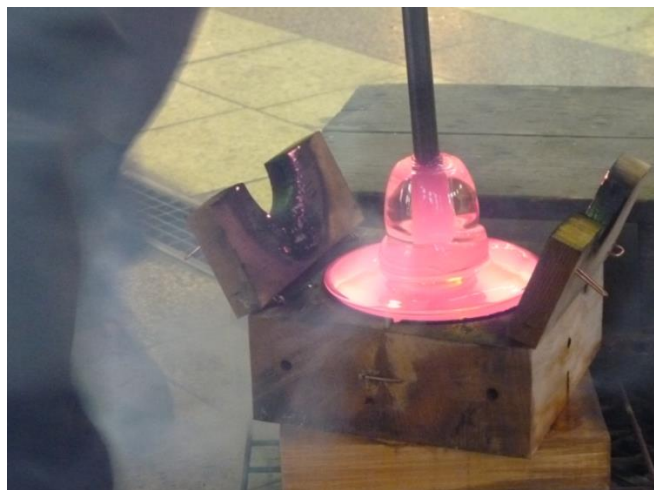
Obrázek 30 Tvarování skla v rotační formě
