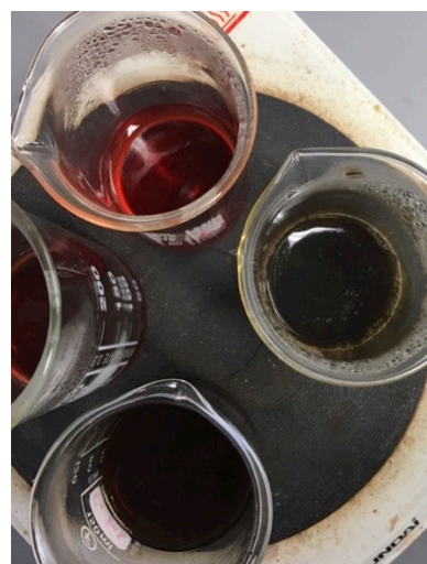
Obrázek 15: Ohřívání roztoků dusičnanů s jablečným extraktem
