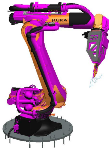
Obr. 12 Skutočná poloha (fialová) a požadovaná poloha (oranžová) PR pri príjazde na náhodnú polohu. Model robota z [31]
