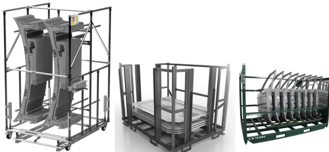
Obr. 4 Prehľad typov rack-ov na rôzne diely z BIW, zľava [8; 9; 10]
