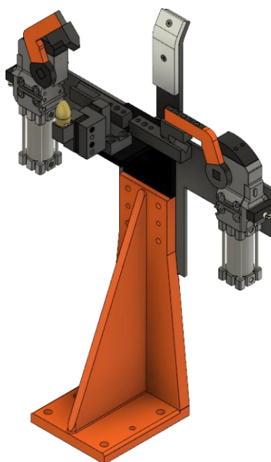
Obr. 3 NAAMS komponenty použité na jednoduchom prípravku [6]
