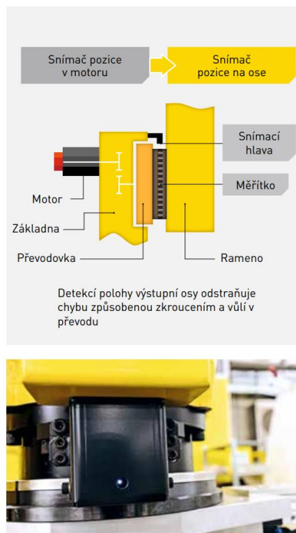
Obr. 15 Enkodéry priamo na ramene robota [47]
