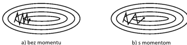
Obr. 32 Porovnanie gradientného zostupu s momentom (rýchlejšia konvergencia, menej kmitá) a bez (pomalšia konvergencia, viac kmitá), prevzaté z [63]
