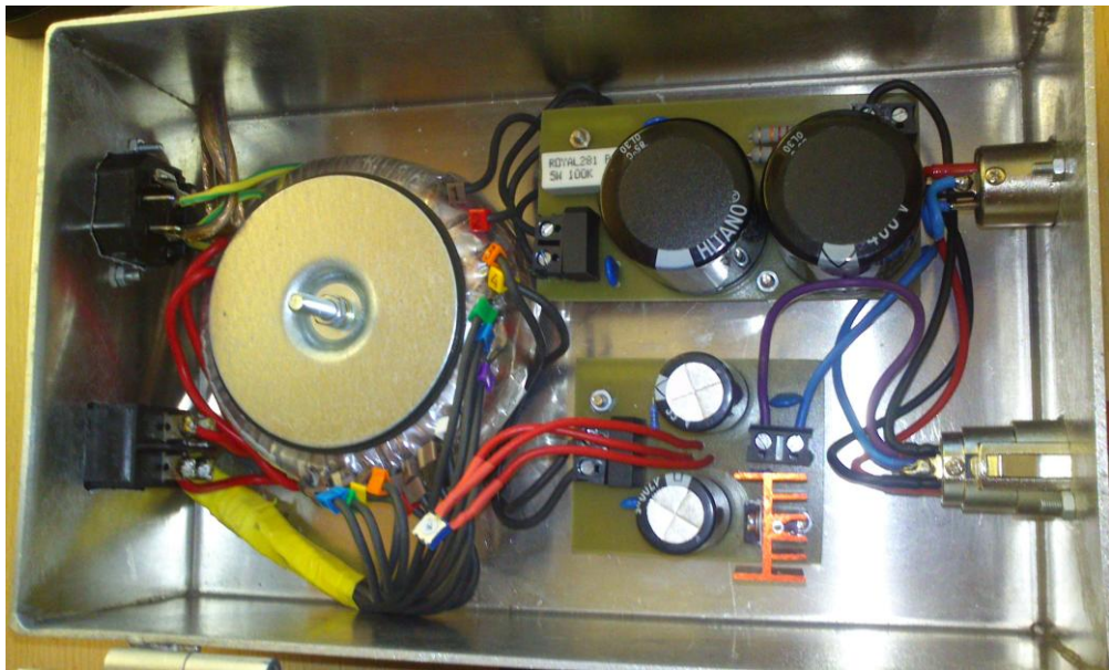
Obr. 22: Zdroj anodového a žhavicího napětí.
