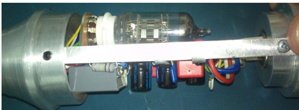
Obr. 25: Vnitřní uspořádání mikrofonní části bez krytu
