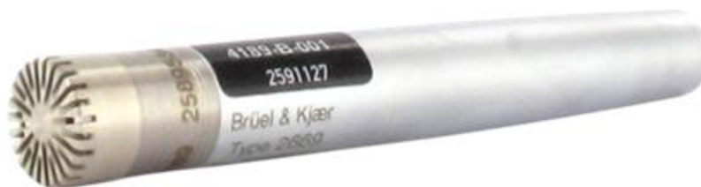
Obr. 20: Kondenzátorový mikrofon B & K 4189 s předzesilovačem B & K 2669 [11].
