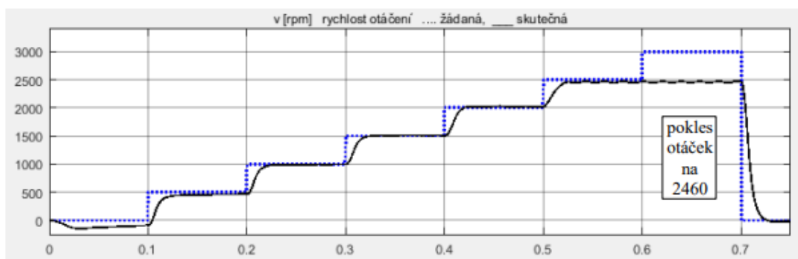
Obr. 15 - Pokles otáčok pri zaťažení 40 Nm v komplexnejšom modeli [33].
