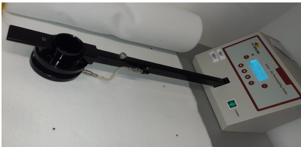
Obrázek 23: Měření prodyšnosti na přístroj SDL MO21A Atlas
