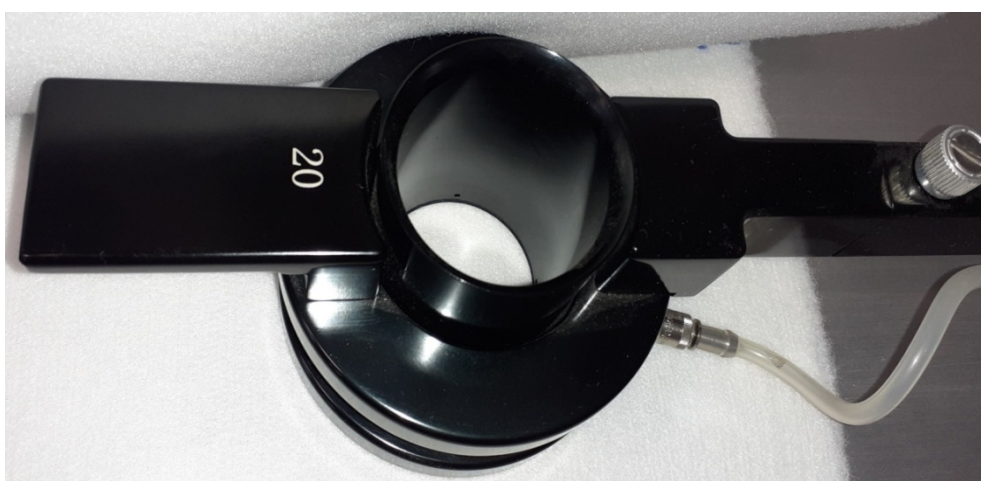
Obrázek 24: Detail testovací hlavy přístroje SDL MO21A Atlas
