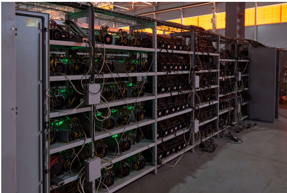
Obrázek 3 Regál plný ASIC minerů těžících Bitcoin
