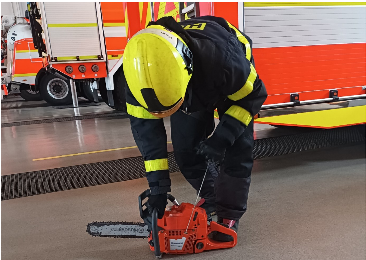
Obrázek 11 start MP s dvoutaktním motorem
