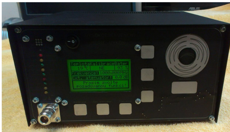
Obrázek 93. Fotografie realizovaného měřiče výkonu
