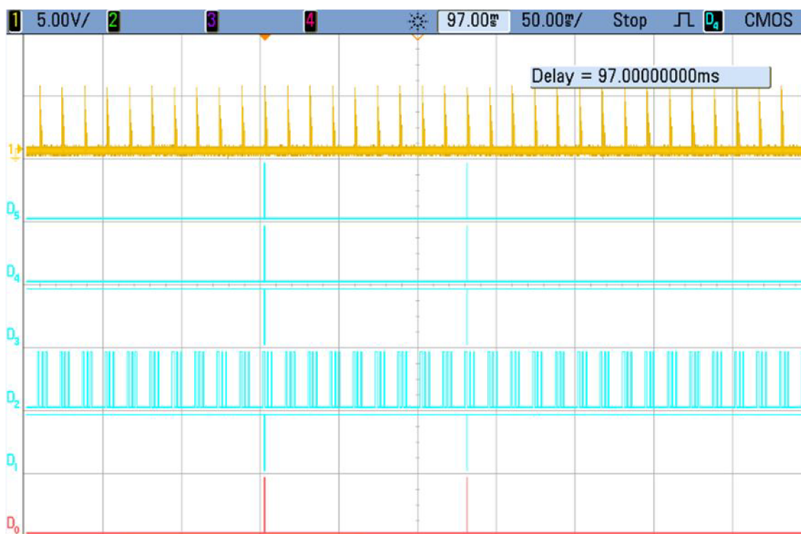
Obrázek 82. Změřené časové průběhy SPI komunikace pomocí logického analyzátoru při stisku klávesy, D0-CHANGE, D1-SS neg., D2-SCK, D3-SS neg., D4-MOSI, D5-MISO, 1-shluk měřících burstů.
