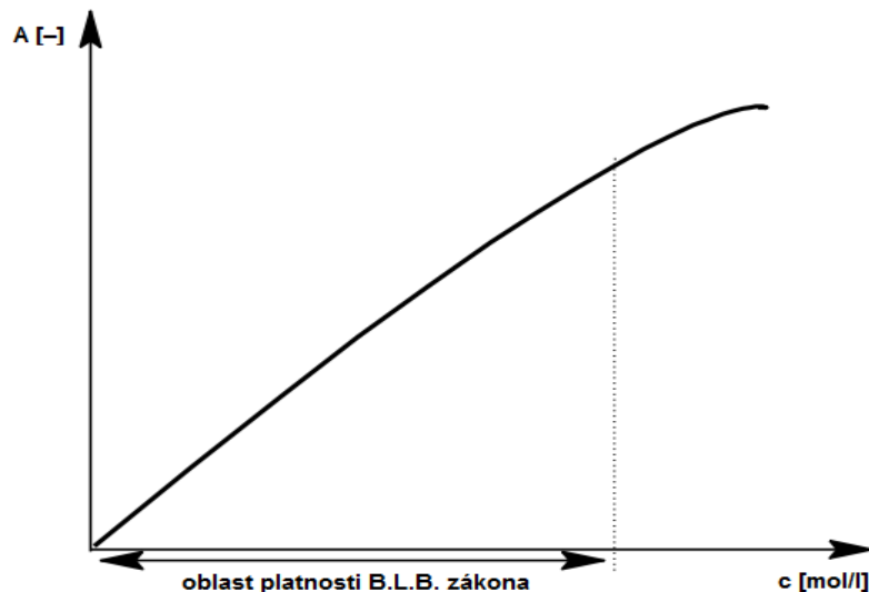
Obr. 7 Graf závislosti absorbance na koncentraci znázorňující lineární oblast použitelnou pro měření [15]
