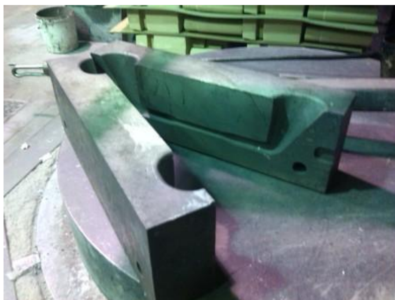
Obr. 19 Nahřívání kokily na víku odporové pece.
