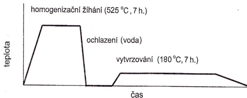
Obr. 20 Diagram tepelného vytvrzování siluminů s obsahem Mg [1].
