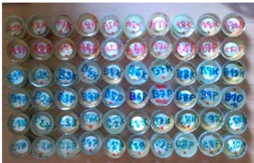
Obr. 29 Vzorky zalité do pryskyřice LH 289 připravené k broušení a leštění.
