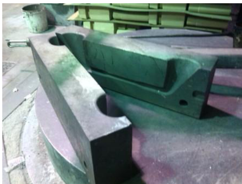
Obr. 19 Nahřívání kokily na víku odporové pece.
