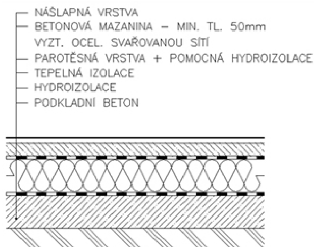
Obr. 7.11: Umístění tepelné izolace v podlaze nad terénem [31].
