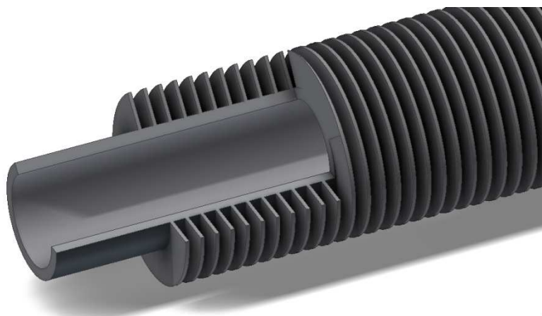
Obr. 14 Model trubky přehříváku 1 a 2 s plným žebrováním
