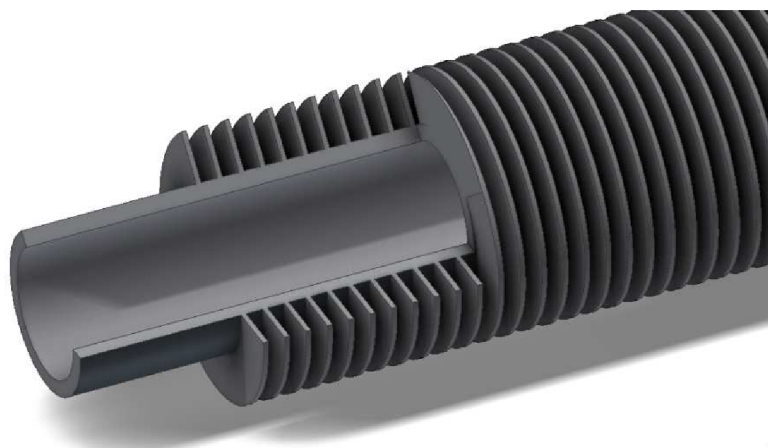
Obr. 14 Model trubky přehříváku 1 a 2 s plným žebrováním
