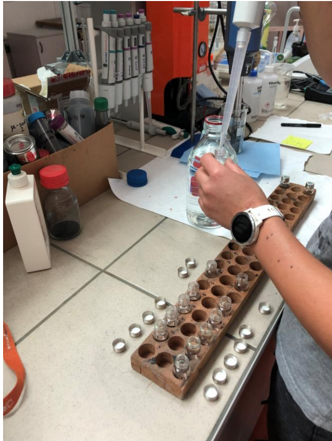
Obrázek 21: Pipetování blanc vzorku [Zdroj: vlastní foto, 10. 6. 2020]
