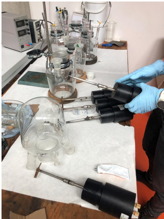
Obrázek 13: Uzávěry na reaktory s míchadlem potřány těsnící mastí [Zdroj: vlastní foto, 10. 6. 2020]
