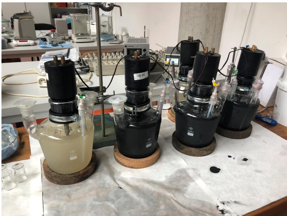
Obrázek 19: Naplněné reaktory se zapnutým mícháním [Zdroj: vlastní foto, 10. 6. 2020]
