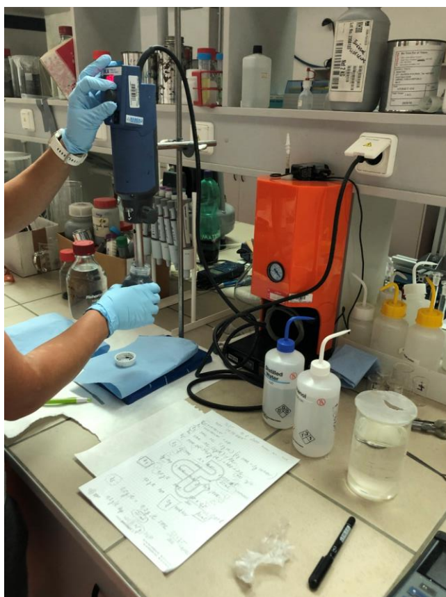
Obrázek 18: Míchání směsi nanoželeza [Zdroj: vlastní foto, 10. 6. 2020]
