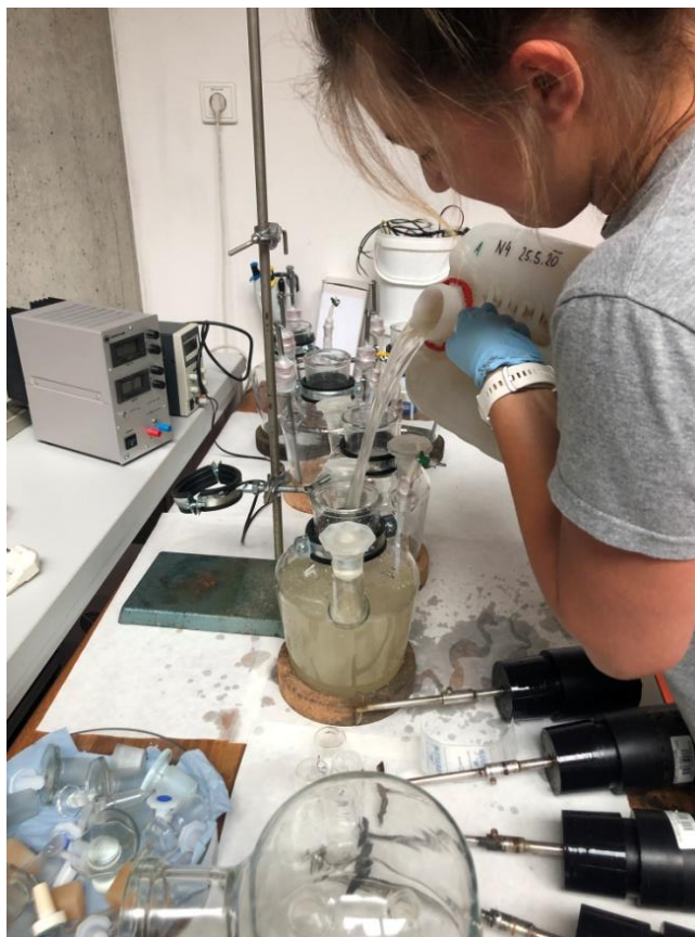
Obrázek 16: Nalévání podzemní vody do reaktorů [Zdroj: vlastní foto, 10. 6. 2020]
