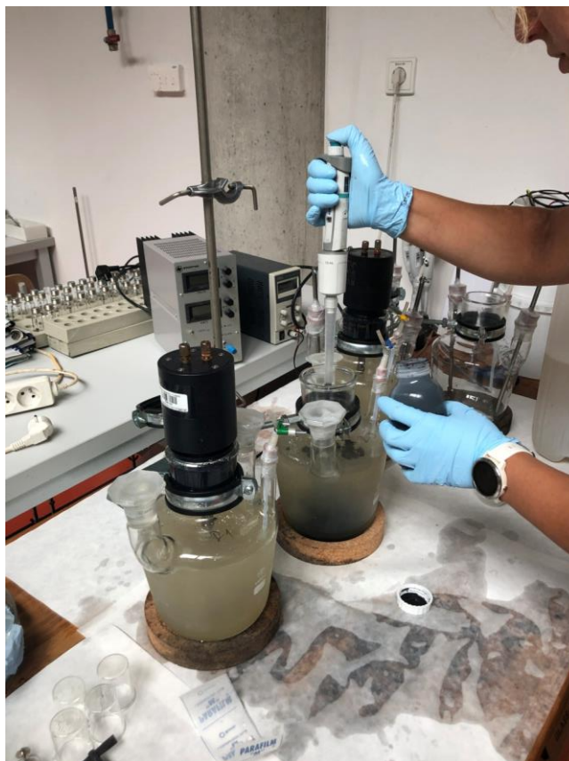
Obrázek 17: Přidávání směsi s nanoželezem do reaktoru R3 pomocí pipety [Zdroj: vlastní foto, 10. 6. 2020]
