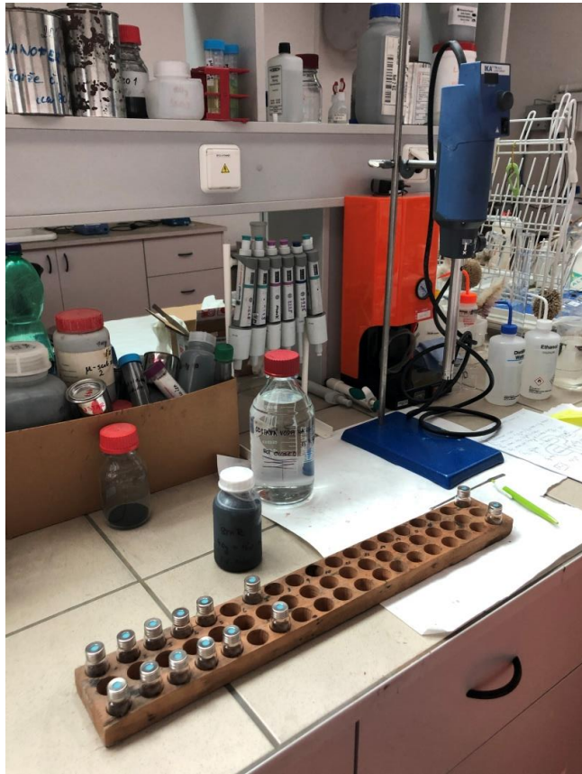
Obrázek 12: Připravené vialky a směs s nanoželezem. [Zdroj: vlastní foto, 10.6.2020]
