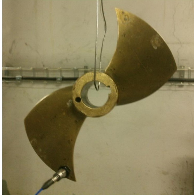
Obr. 6.2 Zavesenie obežného kola a umiestnenie snímača pri meraní
