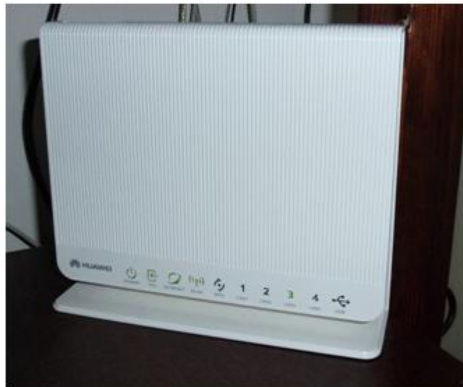
Obrázek 5: Přístupový bod se zabudovanou anténou
