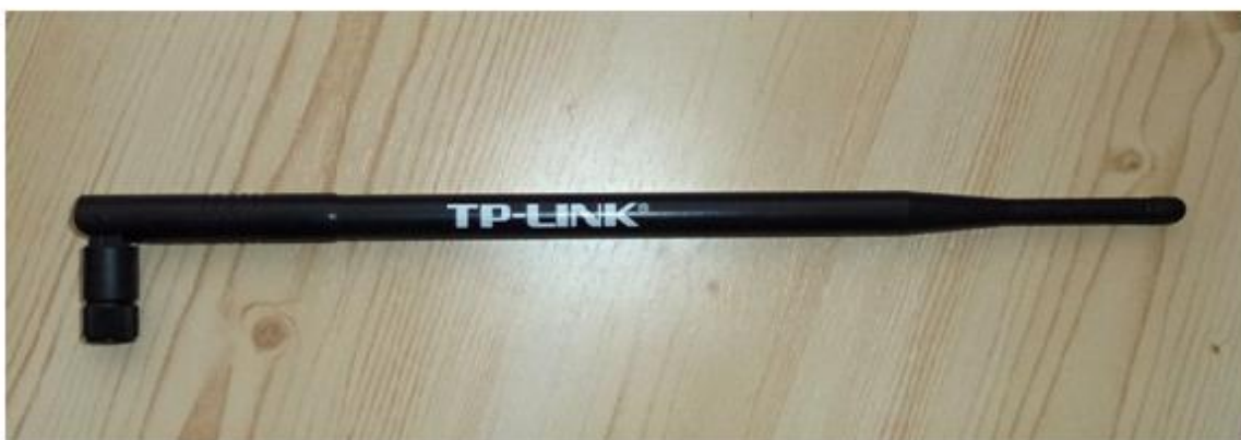
Obrázek 3: Všesměrová anténa pro příjem Wi-Fi signálu
