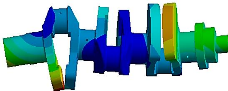
Obr. 38 9. vlastní tvar, frekvence 404,7 Hz.
