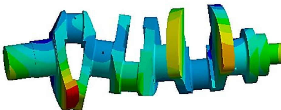
Obr. 40 11. vlastní tvar, frekvence 604,9 Hz.
