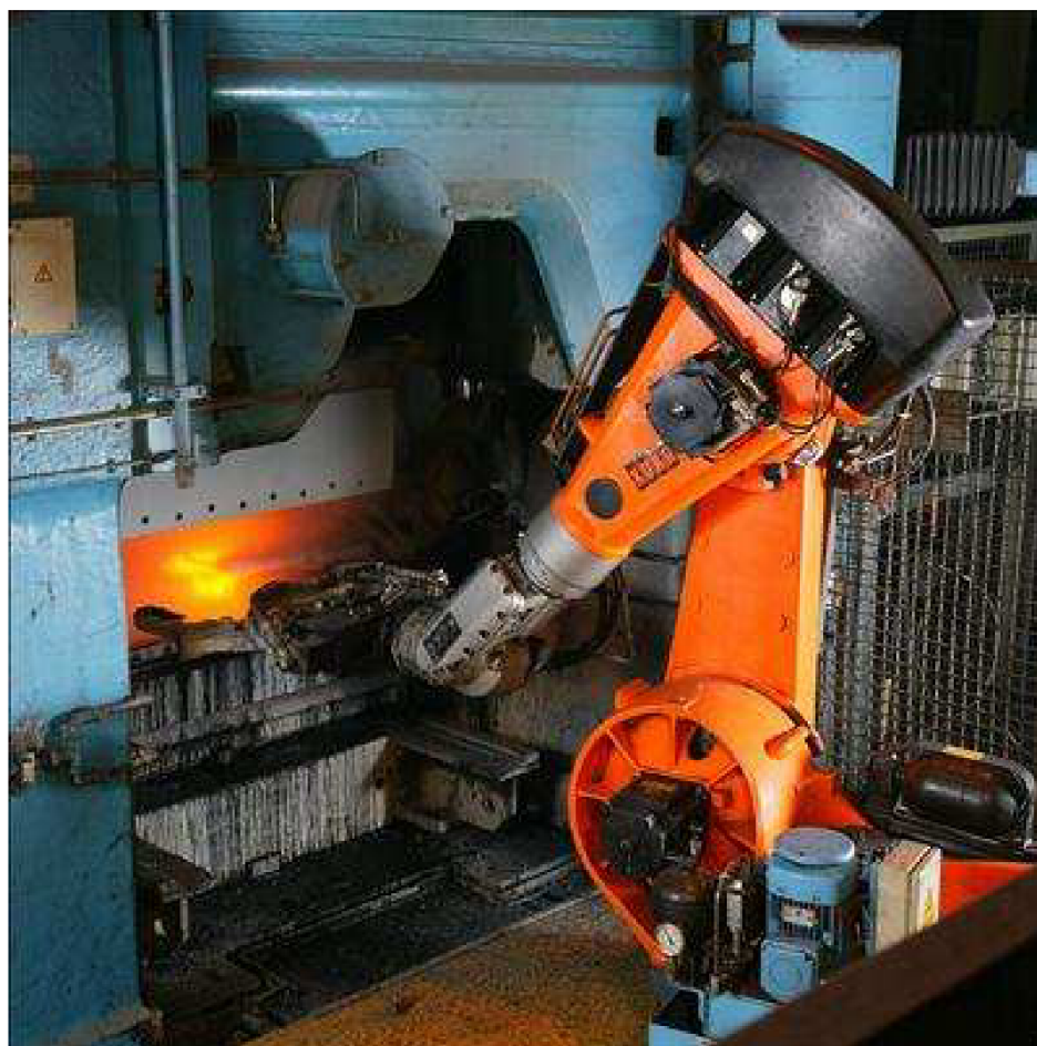
Obr. 14) Průmyslový robot určený k lití kovu [28]
