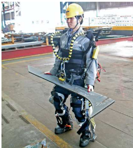
Obr. 7) Robotický exoskeleton pro zvedání těžkých břemen [8]
