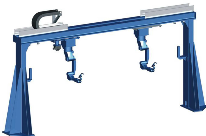
Obr. 23) Pojezdová dráha se závěsným robotem [12]
