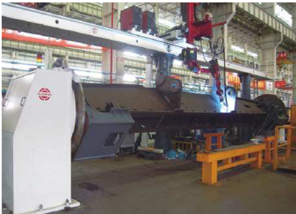
Obr. 41) Svařování nosníku jeřábu [31]
