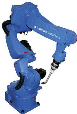
Obr. 16) Sedmiosý svařovací robot (YAKASAWA VA1400) [14]
