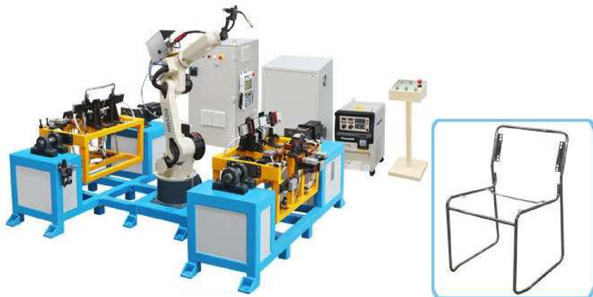
Obr. 40) Robotizované pracoviště pro svařování rámu židlí [30]
