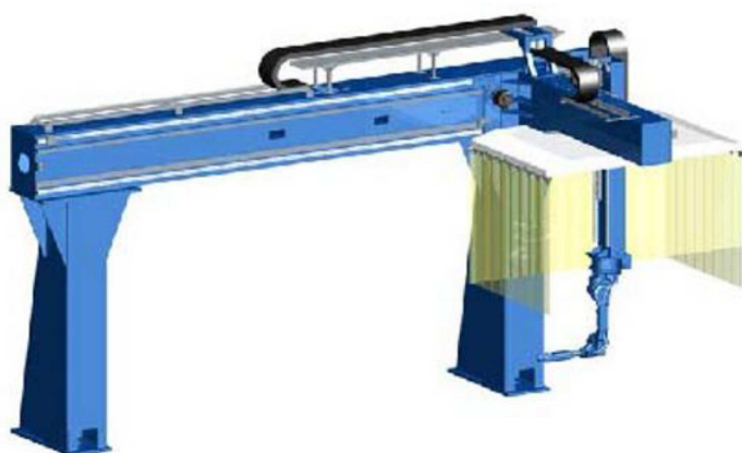
Obr. 24) Víceosá pojezdová dráha se závěsným robotem [12]
