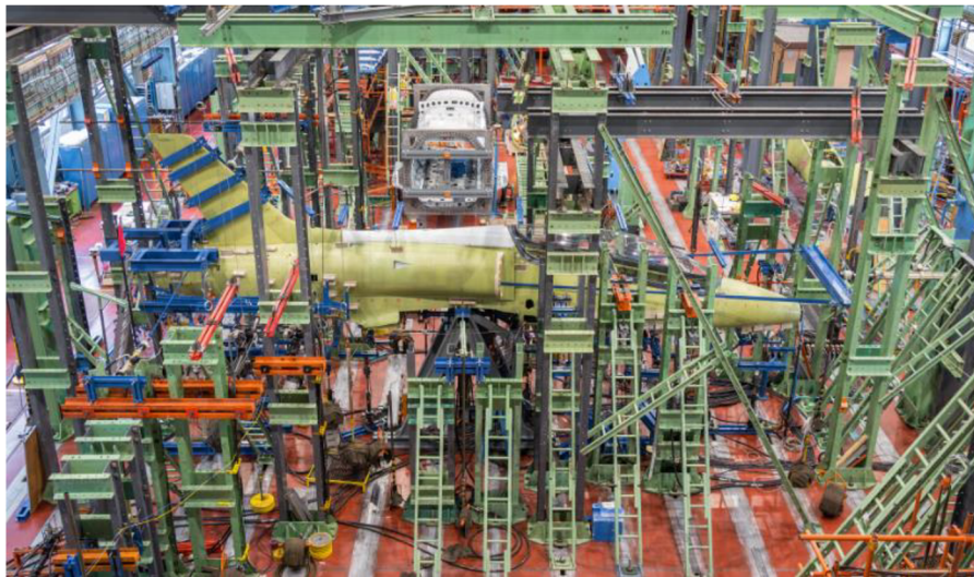
Obrázek 3.1: Zkouška pevnosti trupu letounu L-39NG [5]
