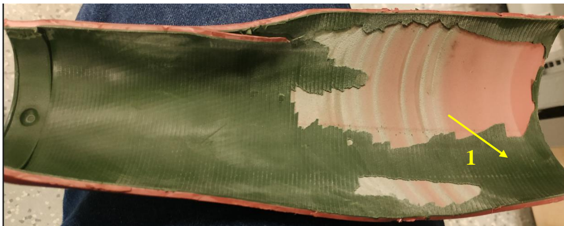
Obrázek 6-17 Rozříznutá poškozená kabelová koncovka
