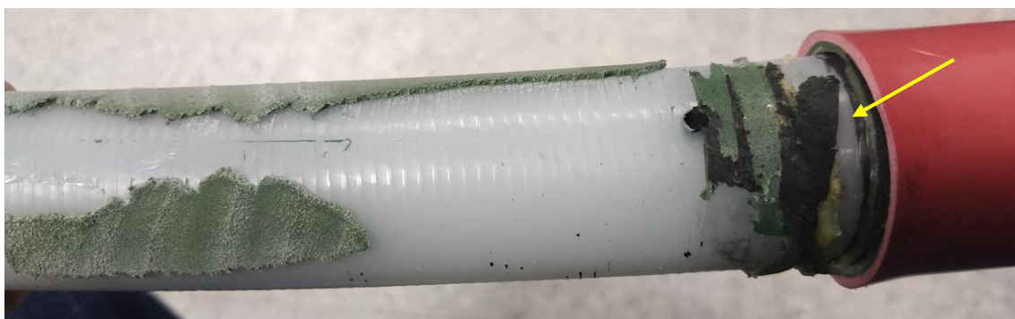
Obrázek 6-18 Zuhelnatělý zbytek řídicí vrstvy po průchodu průrazného výboje
