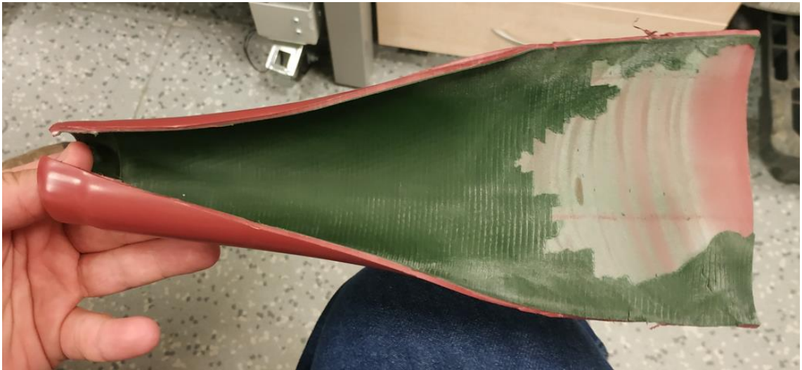
Obrázek 6-16 Rozříznutá referenční kabelová koncovka
