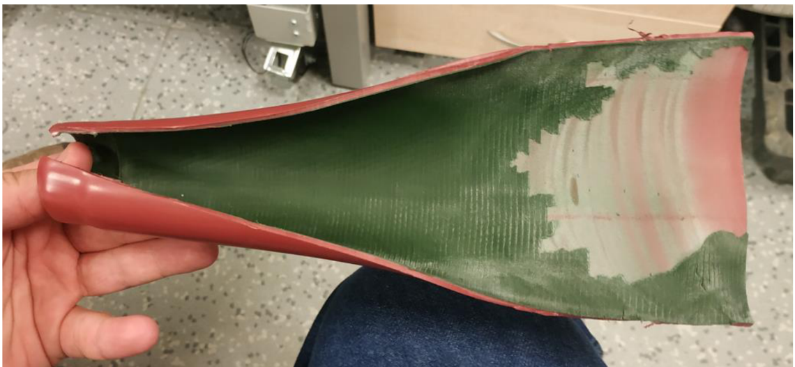
Obrázek 6-16 Rozříznutá referenční kabelová koncovka
