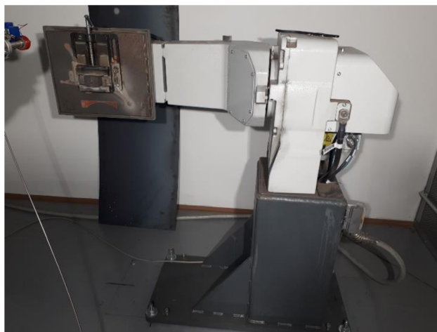
Obr. 12) Polohovadlo IRBP A-250 používaný na pracovisku
