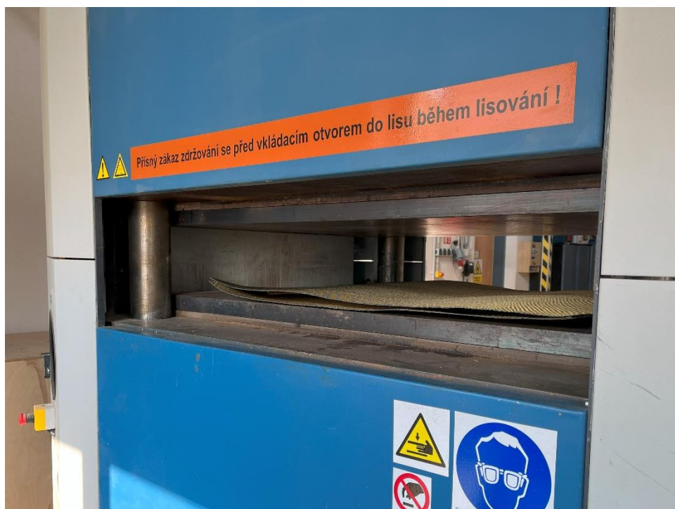
Obr. 5: Ukázka densifikace březových překližek v nerezovém sítu se speciálním úpletem pro zajištění odvodu páry pro potlačení delaminace (LDF MENDELU Brno)
