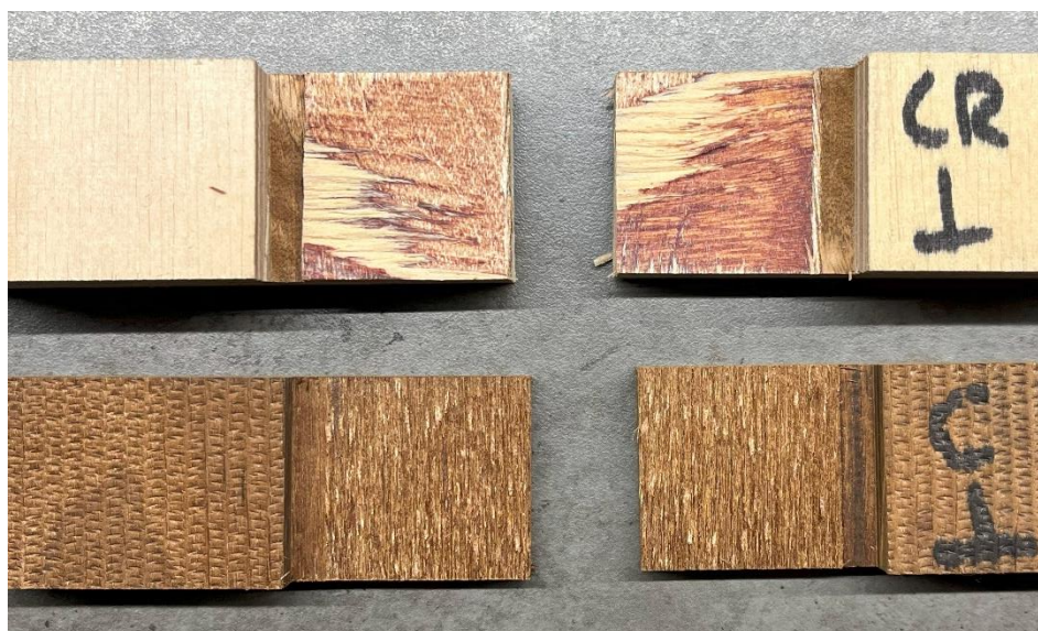
Obr. 10: Ukázka porušení vzorků (lepidlo PRF) po namáhání v místě smykové plochy, horní referenční vzorek se 30% kohezním porušením, spodní densifikovaný vzorek se 100% kohezním porušením v dřevní části vzorku
