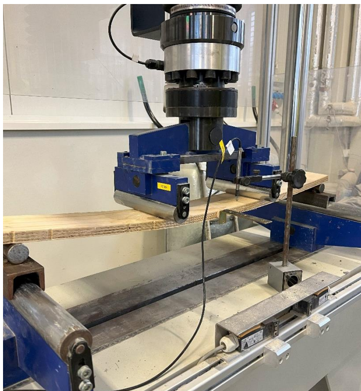
Obr. 13: Zkouška pevnosti v ohybu, působení 4–bodového namáhání
