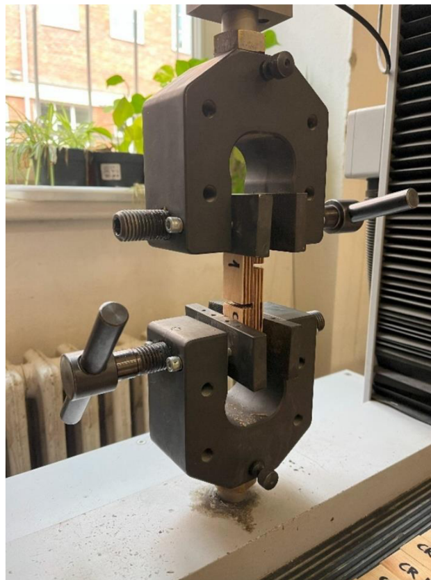
Obr. 9: Referenční zkušební vzorek upnutý mezi drážkovými čelistmi tahového zkušebního lisu M350-20 CT
