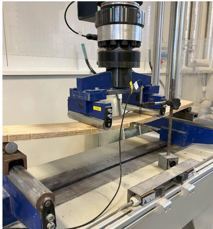
Obr. 13: Zkouška pevnosti v ohybu, působení 4-bodového namáhání
