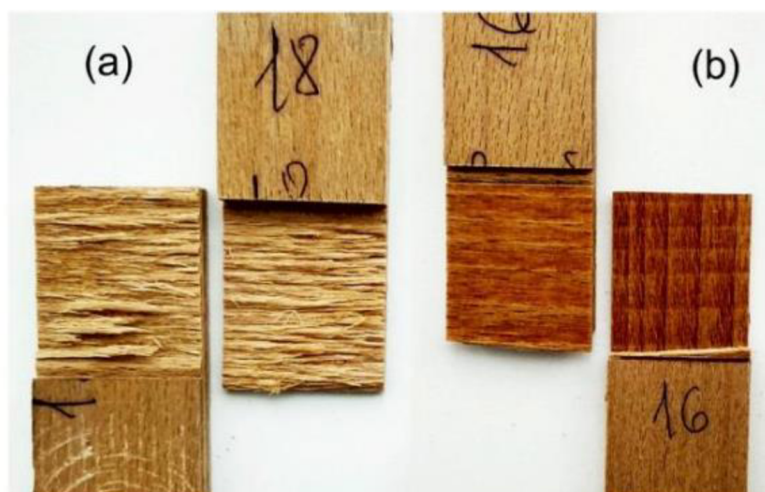
Obr. 3: Porušení dřeva ve vzorcích po zkoušce pevnosti ve smyku: (a) panely s vyšším obsahem lepidla; (b) panely s nižším obsahem lepidla [22]
