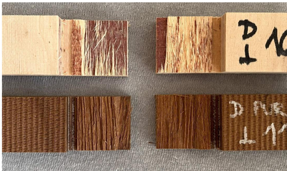
Obr. 11: Ukázka porušení vzorků (lepidlo PUR) po namáhání v místě smykové plochy, horní ref. vzorek s 80% kohezním porušením, spodní densifikovaný vzorek se 100% kohezním porušením v dřevní části vzorku
