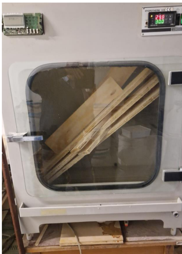
Obr. 12: Uložení vzorků smrkové překližované desky v prostředí 90 %/30 °C
